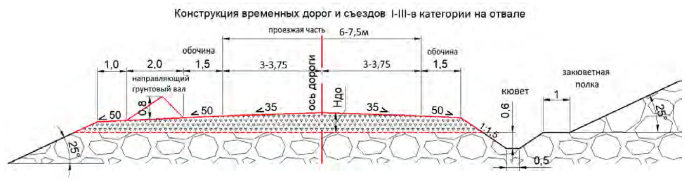
Рисунок 2.1 - Конструктивный поперечник временной автодороги на отвале
